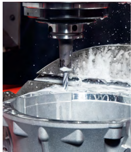
Тонкодисперсная структура и отличная текучесть приводят к значительному снижению расхода СОЖ из-за меньшего выноса.
