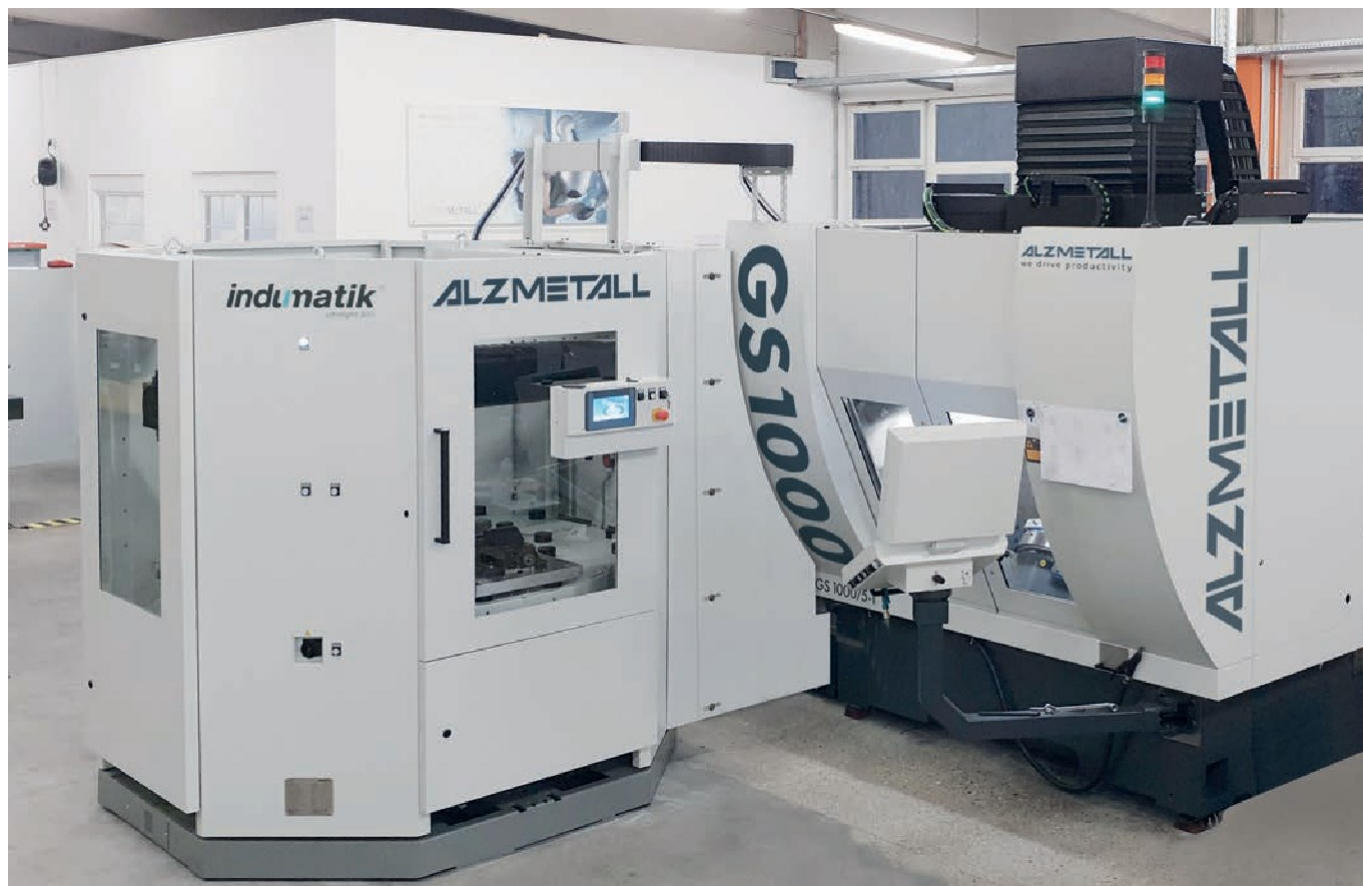
Впровадження ALZMETALL GS 1000 та INDUMATIK Ultralight 300. Максимальна вага вантажу 300 кг, 3-12 позицій для піддонів розміром від 320 x 320 мм до 630 x 630 мм. Привід транспортного засобу для доступу оператора.
