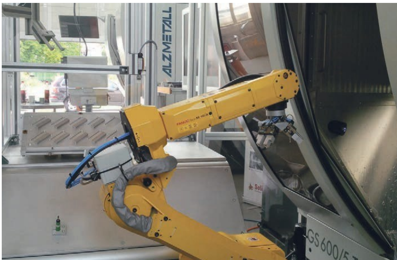
Впровадження ALZMETALL GS 600/5-T та робототехнічної комірки WU RZ-3/20 для обробки конкретних деталей. Вага перенесення 20 кг залежно від встановленого захвату..
